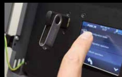
5. Trasferire la configurazione tramite USB o rete LAN al controller
